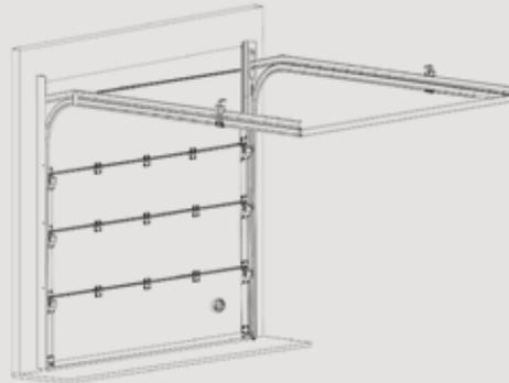
La versione di serie della meccanica residenziale è fornita con binario doppio e molle a trazione poste in verticale (la sicurezza è garantita da un doppio cavo di movimentazione e un sistema a molle concentriche). L'architrave richiesto è di 150 mm e le spallette da 100 mm.
